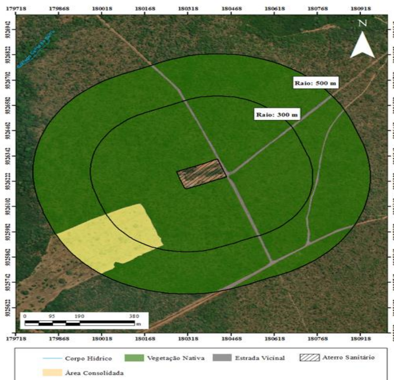
Figura 86 - Área do Aterro Controlado de Cachoeirinha – TO e suas zonas limites nos raios de 300 e 500 m.
